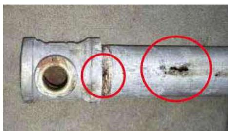
排水管外部の腐食（錆と漏水跡）
