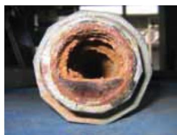
接続部の腐食（錆）
